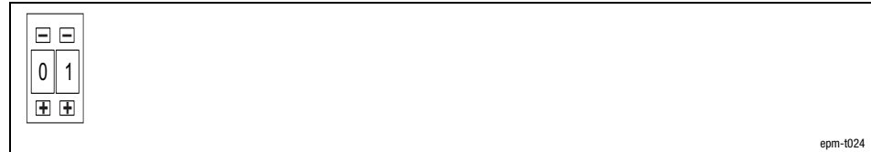
Abb. 4.1-2 Kodierschalter am CAN Gateway
